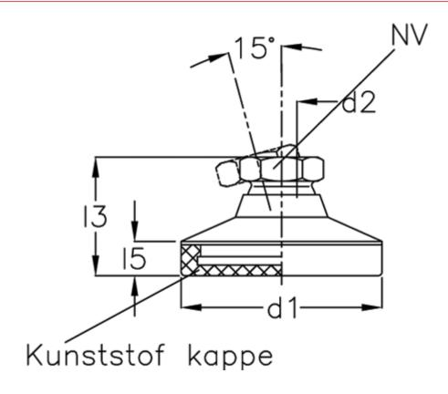
d1 = 40 d2 = 10 l3 = l5 = -NV = 15 Static load (N) = 11 t min = 10.5
